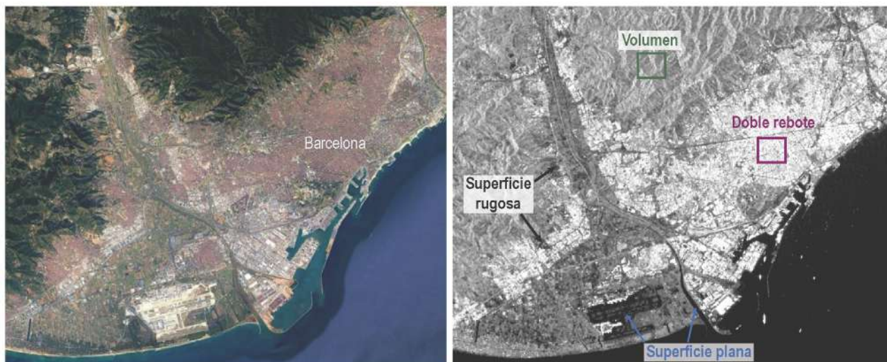
Figura 7: A la izquierda, una imagen óptica de la ciudad de Barcelona adquirida por el satélite Sentinel-2 de la ESA. A la derecha, una imagen geocodificada, que muestra el coeficiente de retrodispersión de la intensidad de la señal SAR de la misma zona. En esta imagen adquirida por el satélite Sentinel-1 podemos observar ejemplos de los diferentes dispersores de la señal radar (Figura 6). Las superficies planas, como el mar sin oleaje, aparecen de color negro. Los objetos que producen doble rebote, como los edificios o los barcos, se ven blancos o brillantes. En las zonas donde existe vegetación se produce dispersión de volumen. Las superficies rugosas adquieren diferentes tonalidades de grises. Para más detalles sobre los tipos de calibración y las escalas de visualización, consultar la calibración radiométrica .
